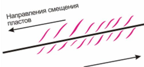
Рис. 3.28. Трещины оперения при разнонаправленном смещении блоков
